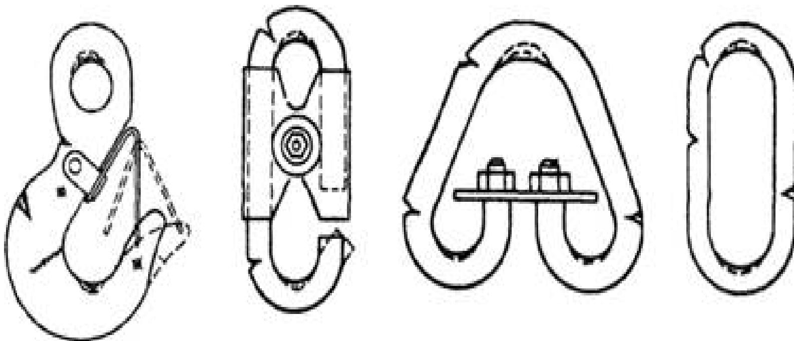
**Рис. 26. Недопустимые дефекты концевых элементов стропов**
