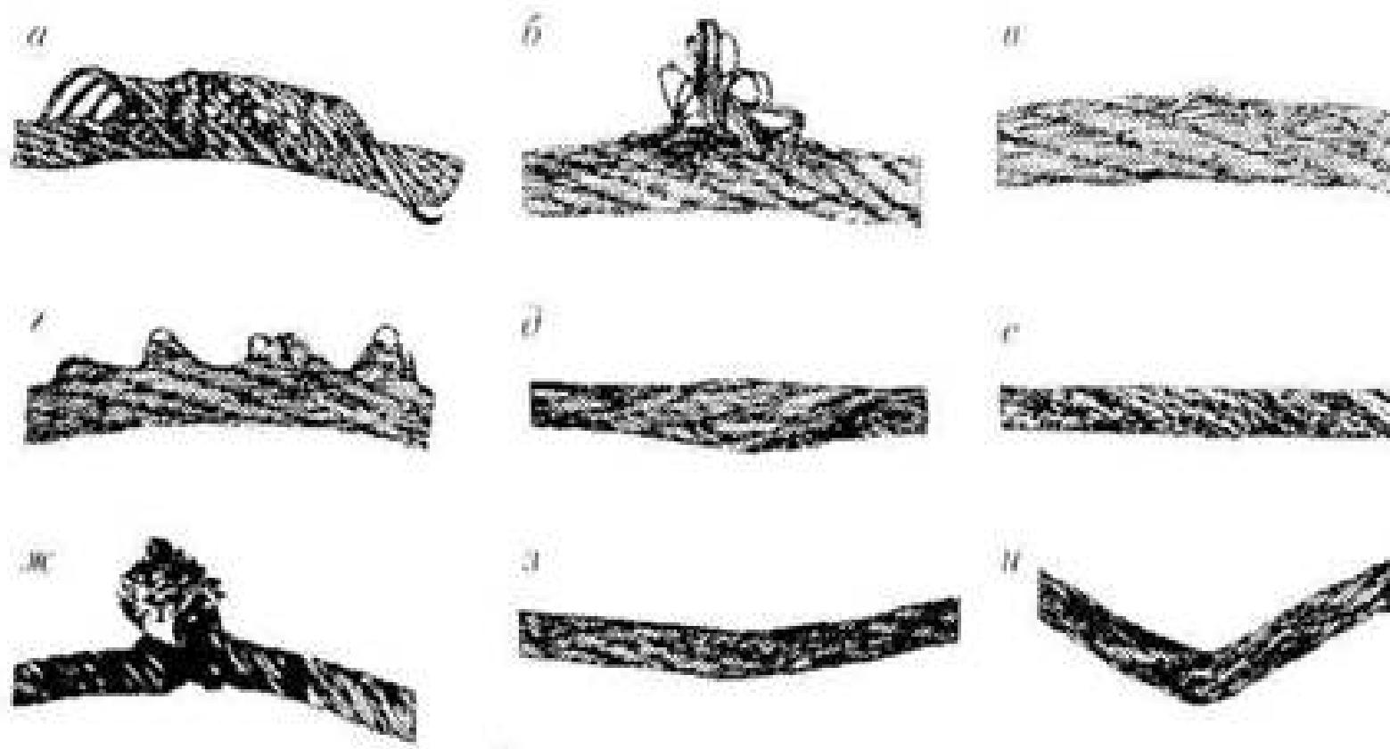
**Рис. 30. Деформации канатного стропа:**
