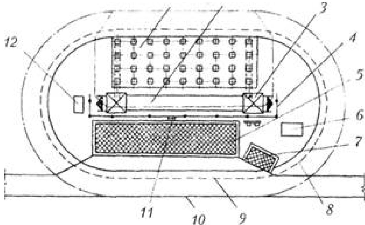
**Рис. 41. Опасные зоны при работе башенных кранов:**
