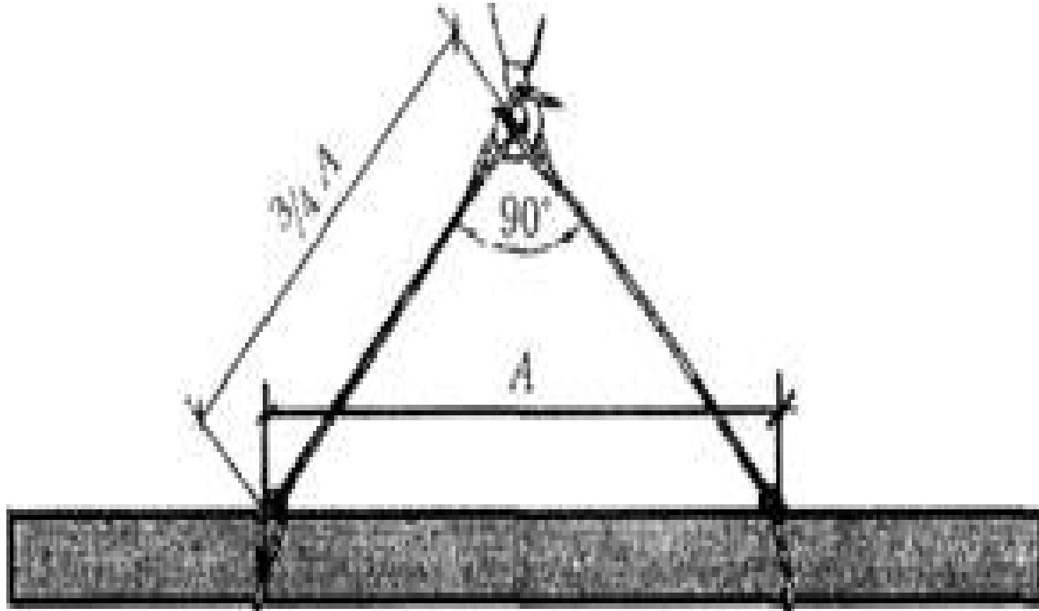
Рис. 31. Определение длины ветви стропа
