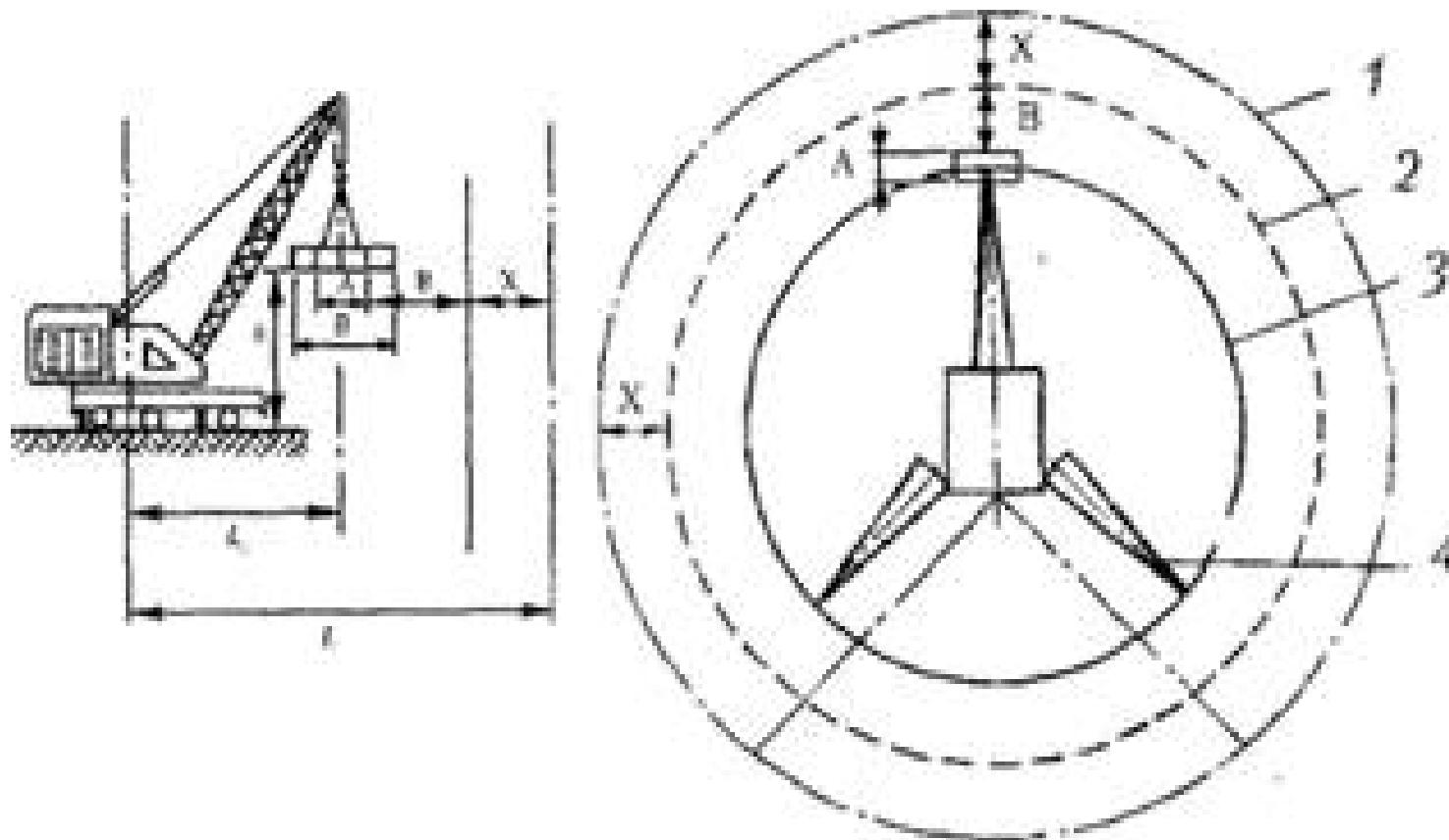
**Рис. 42. Опасные зоны при работе стреловых кранов:**
