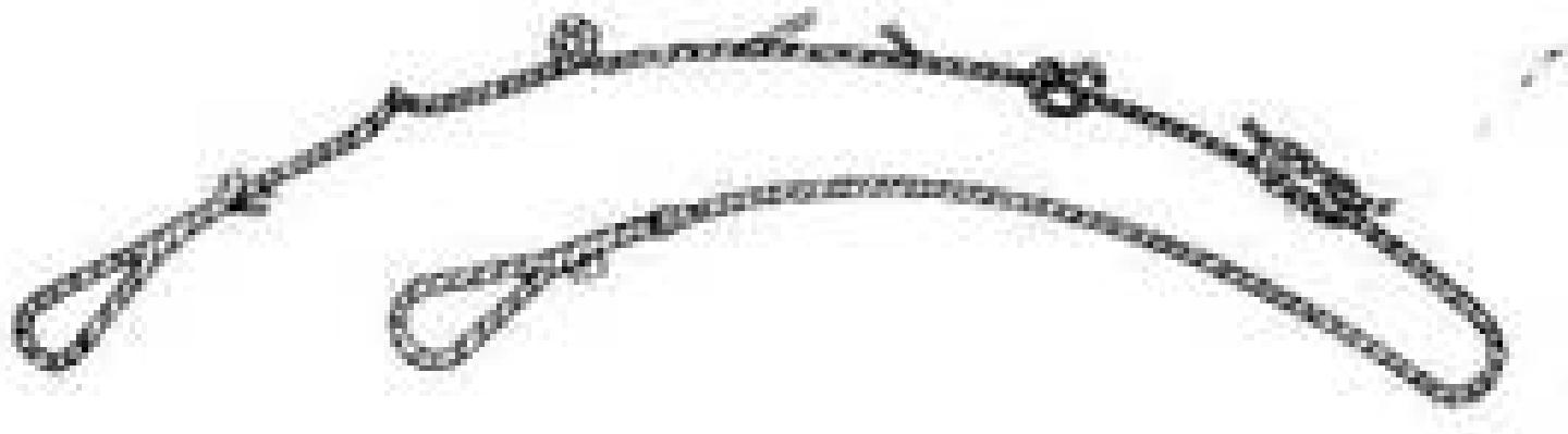
**Рис. 29. Недопустимые дефекты гибкого элемента канатного стропа**
