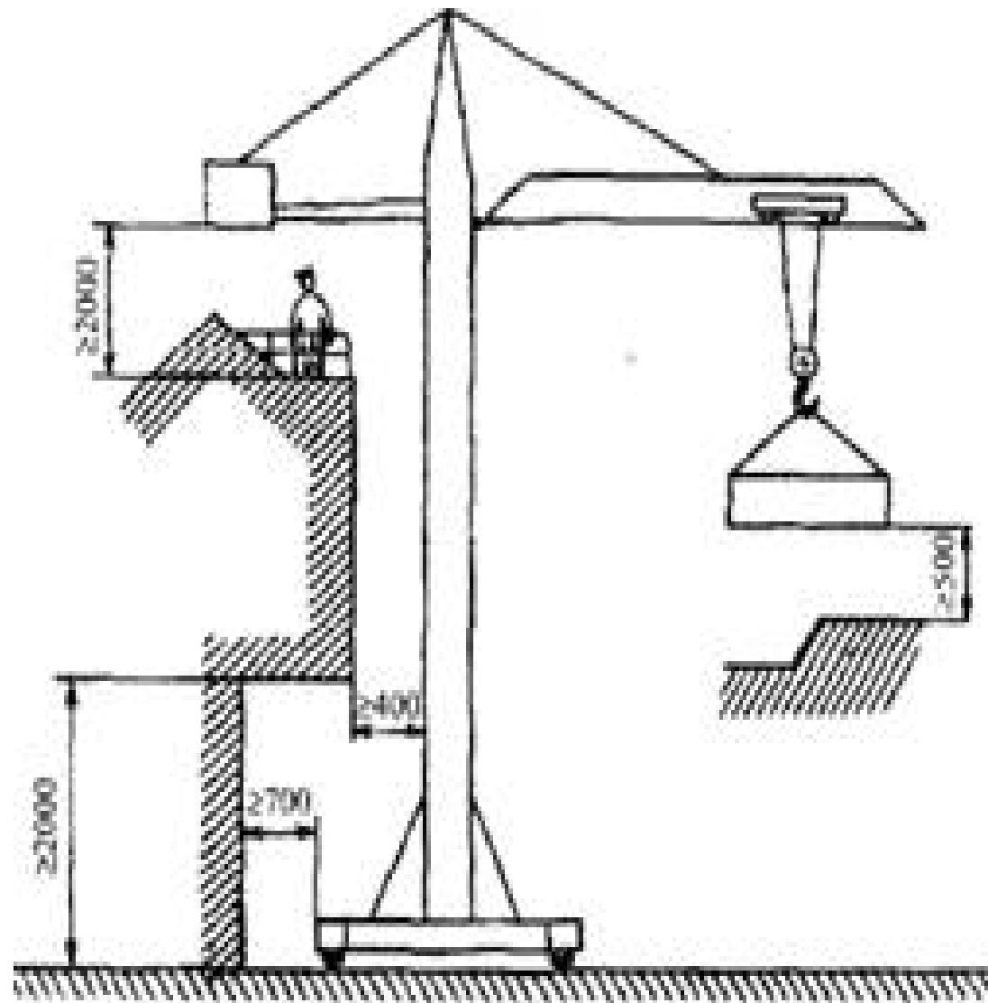
**Рис. 38. Схема установки кранов, передвигающихся по наземным рельсовым путям**
