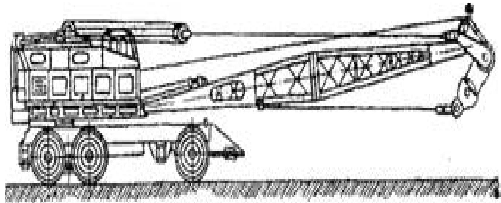
**Рис. 9. Пневмоколесный кран**
