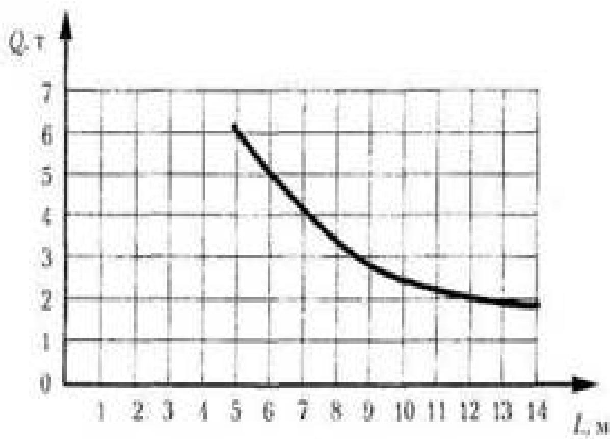
Рис. 13. Грузовая характеристика стрелового крана
