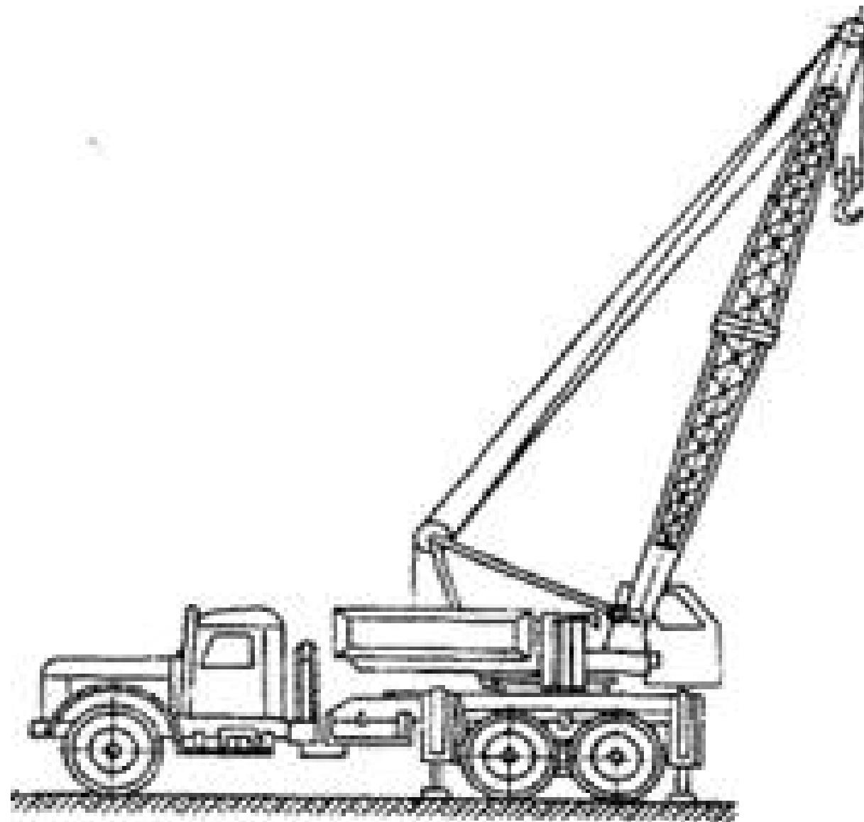
**Рис. 10. Автомобильный кран**
