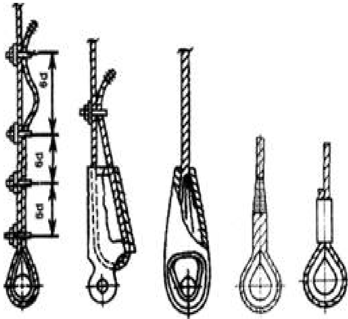
**Рис. 20. Способы выполнения петли на конце каната:**
