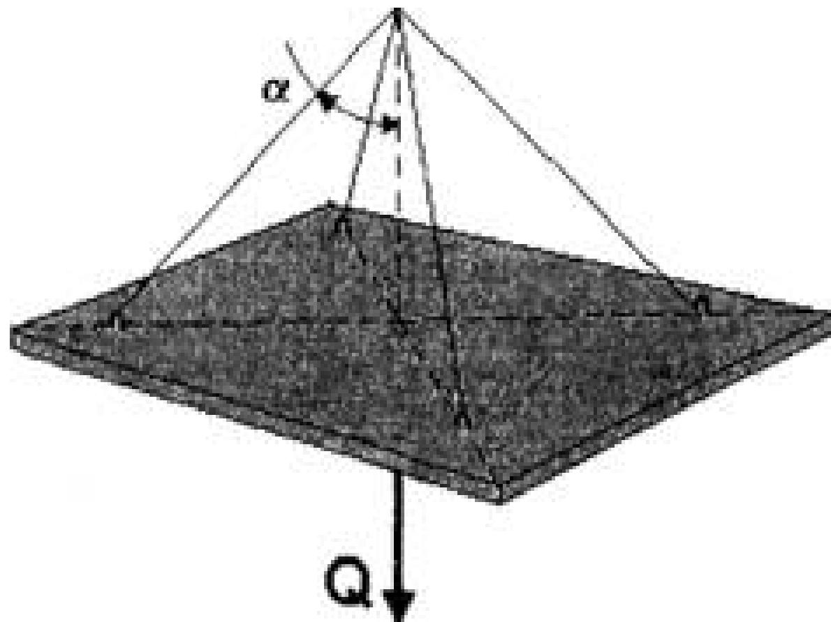
Рис. 21. Определение натяжения ветви стропа
