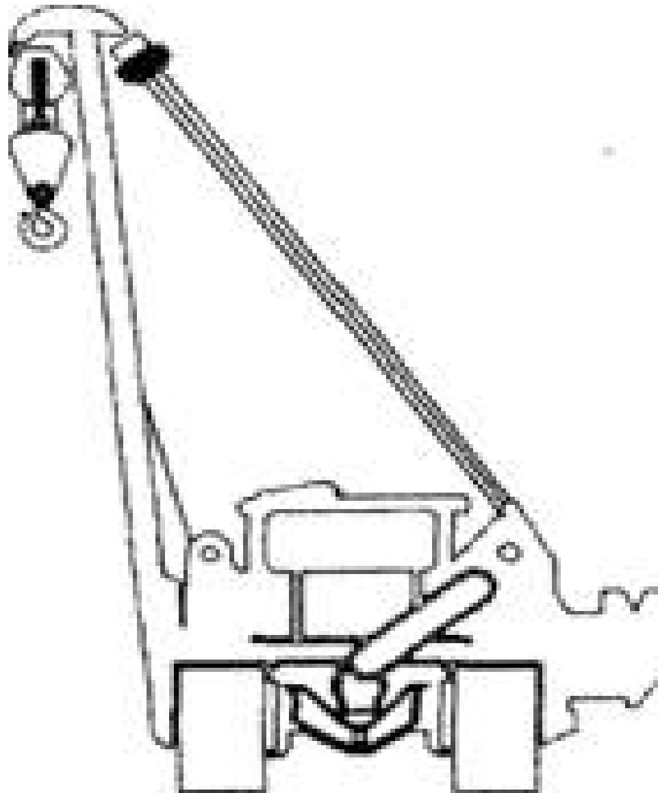
Рис. 11. Кран – трубоукладчик
