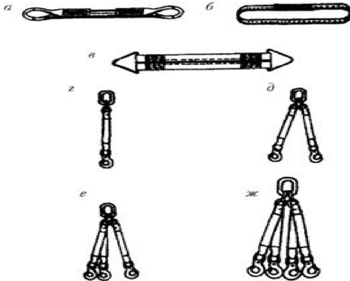
**Рис. 24. Грузовые стропы на текстильной основе:**
