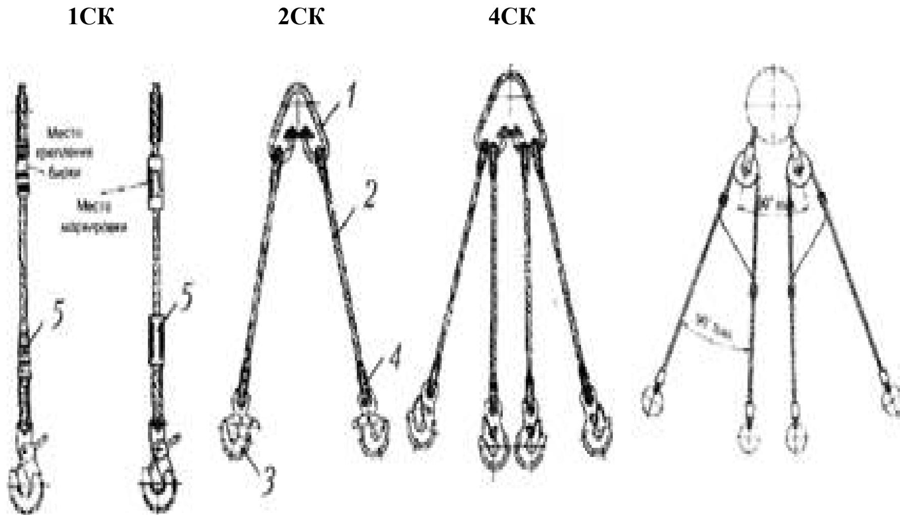
**Рис. 23. Устройство ветвевых канатных стропов:**
