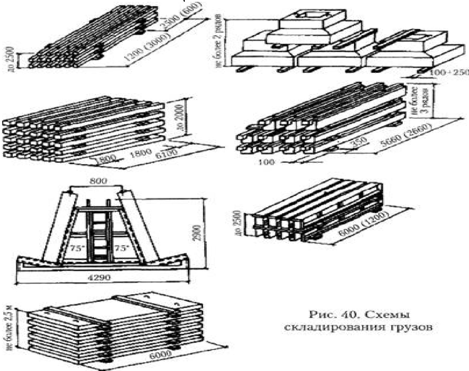
Рис. 40. Схемы складирования грузов
